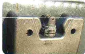
Fertig montiertes Sudhaus-schloss an einem Ochsner-Kunststoffcontainer.
