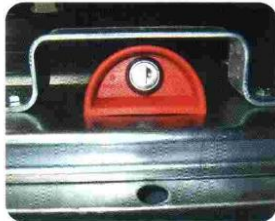
Fertig montiertes Sudhaus-schloss an einem 800-l-Ochsner Stahlcontainer.
