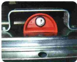
Fertig montiertes Sudhaus-schloss an einem 800-l-Ochsner Stahlcontainer.
