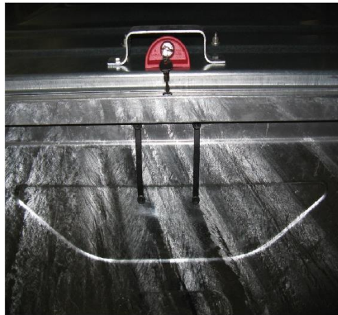
Fertig montiertes Sudhaus-schloss an einem Ochsner-Kunststoffcontainer.
