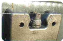
Fertig montiertes Sudhaus-schloss an einem Ochsner-Kunststoffcontainer.
